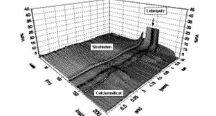
(2) Zeitlicher Verlauf des Wassergehaltsprofils in der Mitte der Strohhalmmauerung
